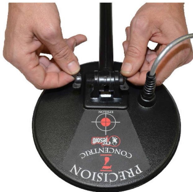
Figura 4 - de montaje de la bobina a palo inferior
