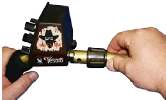
Figura 6 - Coloque Asambleas Pole Medio y Superior
