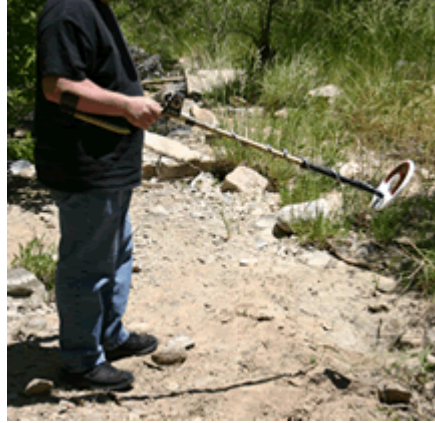
Figura 13 - No inclinar la bobina en un ángulo de la tierra
